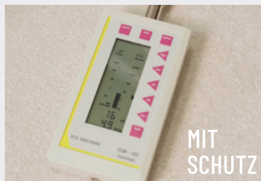
Messung über Bodensteckdose mit Sh-Strahlenschutz-Teppich Ergebnis: ca. 5 Volt pro Meter
